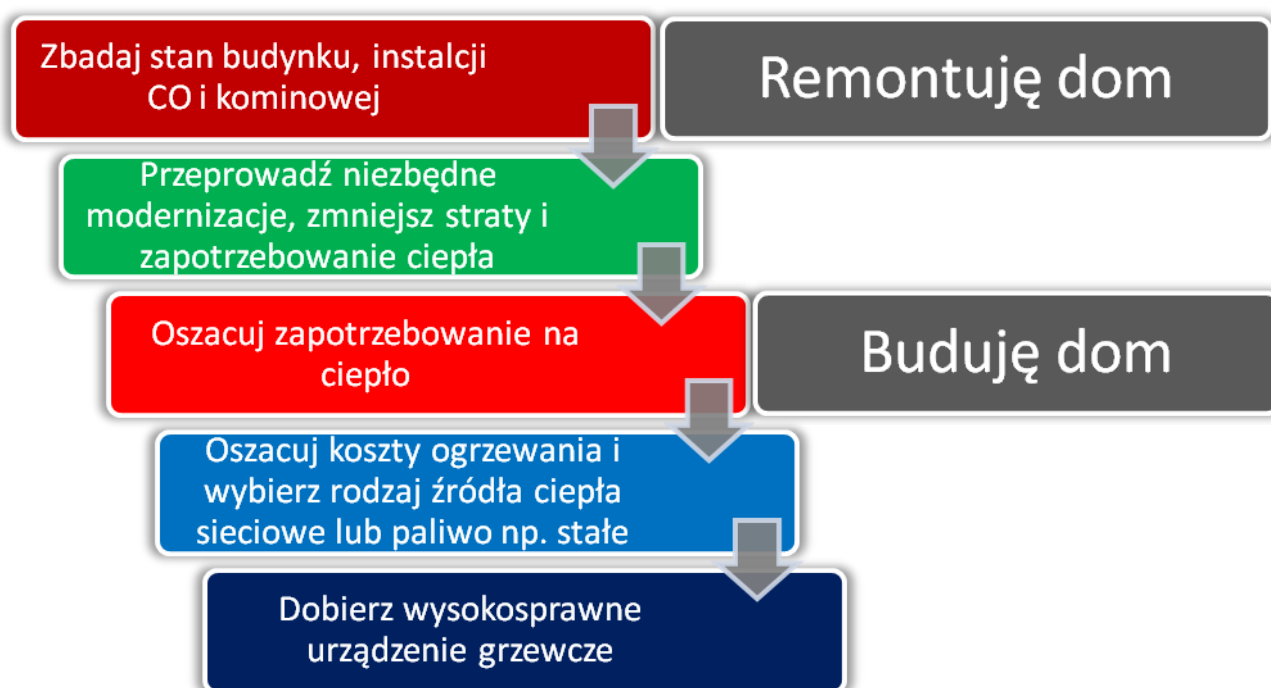
Rys. 20. Algorytm doboru źródła ciepła - urządzenia grzewczego
